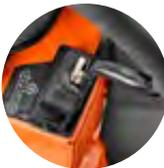
Automatische, in den Steuerhebeln integrierte Feststellbremse
