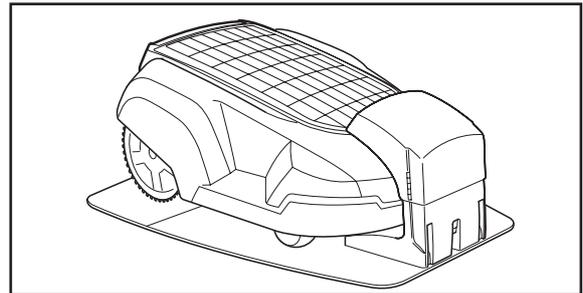
Ein guter Kontakt entsteht, wenn beide Ladebleche des Mähers mittig an den Kontaktblechen der Ladestation anliegen.
