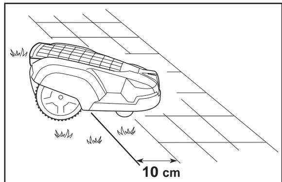
Wird der Arbeitsbereich durch einen gepflasterten Weg auf Rasenhöhe geteilt, kann Automower® über den Weg fahren. Das Begrenzungskabel kann vorzugsweise unter den Wegplatten verlegt werden. Es ist ebenfalls möglich, das Begrenzungskabel in den Fugen zwischen den Wegplatten zu verlegen.
