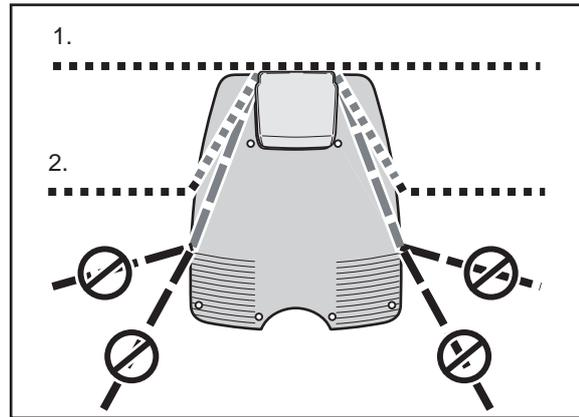
Beim Anschluss an die Ladestation muss das rechte Ende des Begrenzungskabels in die rechte Öffnung und das linke Kabelende in die linke Öffnung eingeführt werden.
