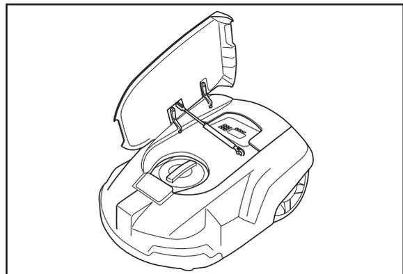
3. Den Drehknopf in die gewünschte Position stellen. Die gewählte Position ist die Markierung am Drehknopf, die sich vor dem Pfeil am Gehäuse befindet.
