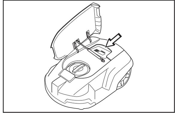
Die Bedientafel besteht aus einem Display und einer Tastatur. Alle Informationen werden auf dem Display angezeigt, und alle Eingaben werden mit den Tasten vorgenommen.
